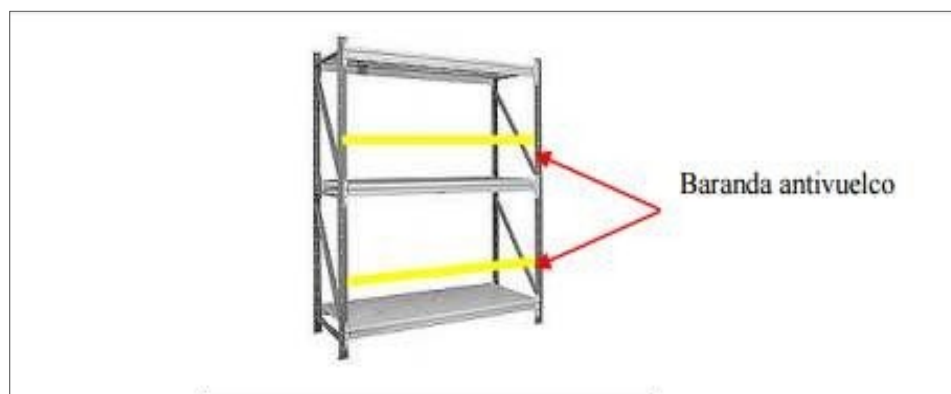
Figura1. Estantería con baranda antivuelco
